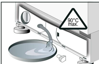
4. Opatrně vyšroubujte víčko čerpadla, zbytková voda může vytéct. Vyčistěte kryt čerpadla a odstraňte všechny cizí předměty. Oběžné kolo ve vypouštěcím čerpadle se musí otáčet.
